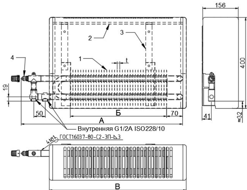
**Рис. 1 Конвектор «Универсал» КСК-20 СН -2... К в ниж./лев. рез.**
